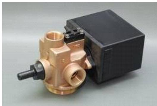
5-Stufen-Zentralsteuerventil (4 Schaltstellungen) für Enthärtungsanlagen von Trink- und Brauchwasser; geeignet für die Ausrüstung von Einfilter- und Doppelfilteranlagen von 10 – 150 Liter Austauscherharz (pro Säule).
