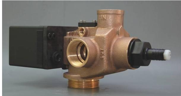
5-Stufen-Zentralsteuerventil (4 Schaltstellungen) für Enthärtungsanlagen von Trink- und Brauchwasser; geeignet für die Ausrüstung von EinfILTER- und Doppelfilteranlagen von 50 – 350 Liter Austauscherharz (pro Säule).
